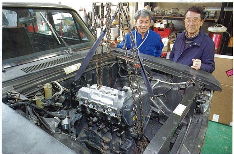
● さすがに50年前のノーマル車では戦闘力が低いため、エンジンとミッションはアルテッツァ用に換装する。写真のエンジンは大きさの目安であり、実際に搭載するエンジンを確保するため、これからドナー車両を探すのだそうだ。
